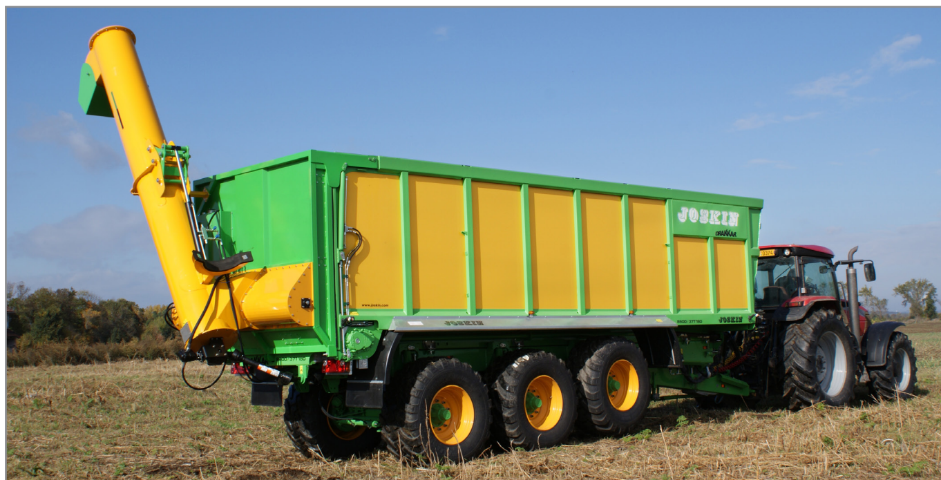
DRAKKAR con tornillo de transbordo y sistema de pesado dinámico que permite, durante la descarga dentro de un semi-remolque, respetar las reglamentaciones vigentes.
